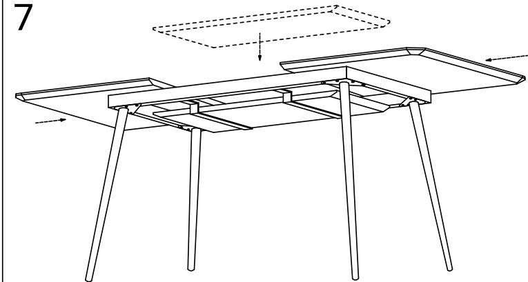
Для установки вставки в сложенном положении столешницы, вставку повернуть как показано на схеме, установить на скобы и сдвинуть столешницу с двух сторон.
