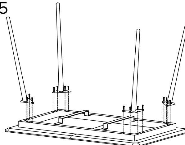
Установить ножки к раме при помощи крепежей (винт M6x20)
