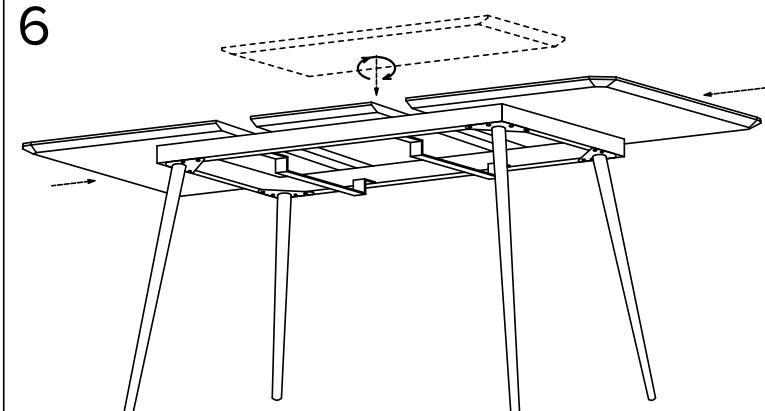
Перевернуть стол, раздвинуть створки столешницы. Для установки вставки в разложенном положении столешницы, вставку повернуть как показано на схеме и сдвинуть столешницу с двух сторон.
