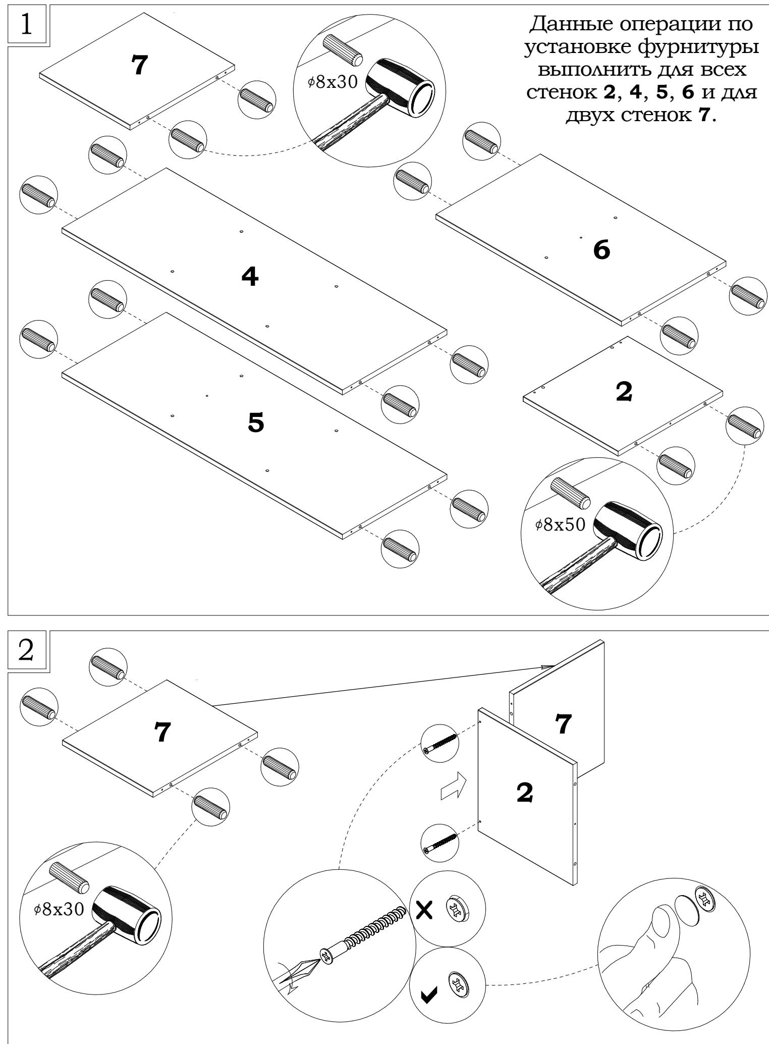
Данные операции по установке фурнитуры выполнить для всех стенок **2, 4, 5, 6** и для двух стенок **7**.
