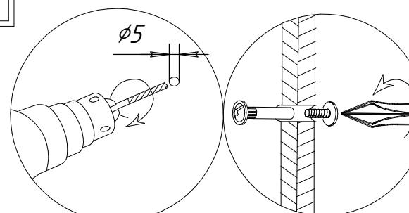
Стеллажи можно соединять между собой при помощи межсекционных стяжек. Для этого необходимо просверлить отверстия  $\phi 5$  мм в соседних стенках, предварительно выровняв изделия.
