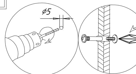
Стеллажи можно соединять между собой при помощи межсекционных стяжек. Для этого необходимо просверлить отверстия  $\phi 5$  мм в соседних стенках, предварительно выровняв изделия.
