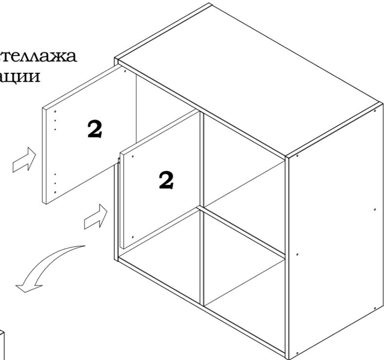
Выставьте вровень с задней кромкой горизонтальных стенок стеллажа и зафиксируйте шурупами 4x25
