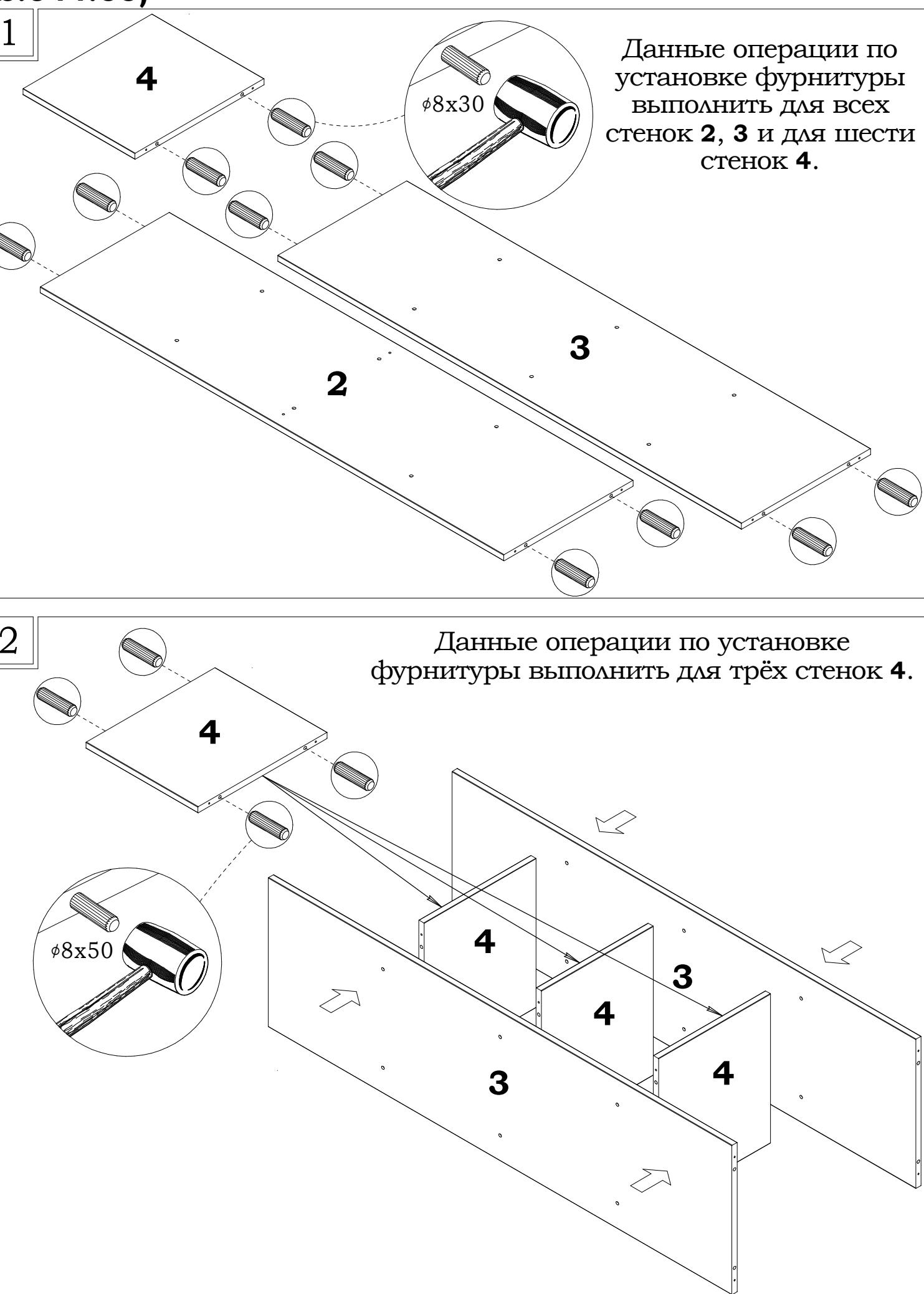
**Инструкция по сборке стеллажа 16 секций Scout (Скаут) 142,4\*142,5\*39
