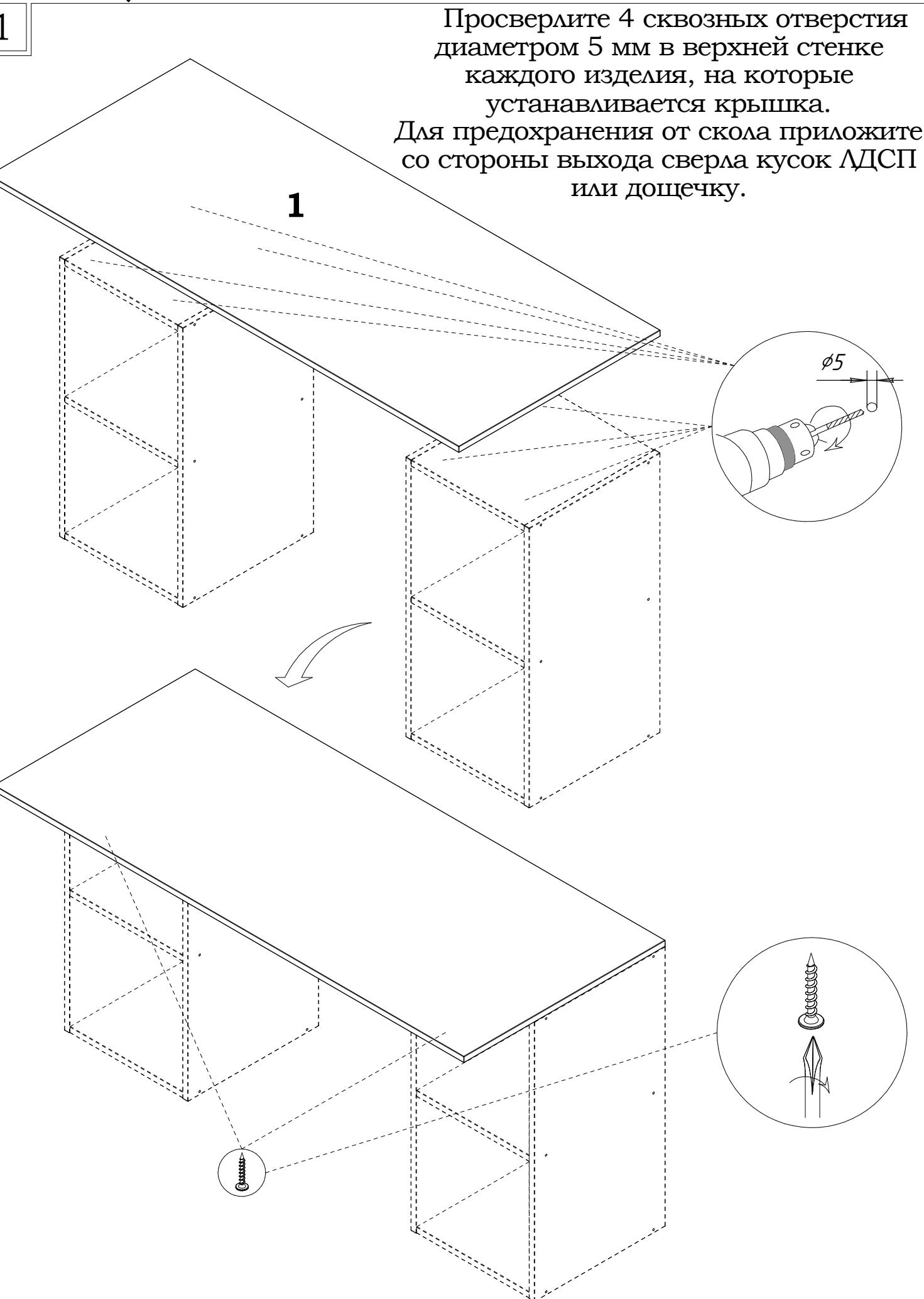
Просверлите 4 сквозных отверстия диаметром 5 мм в верхней стенке каждого изделия, на которые устанавливается крышка.
