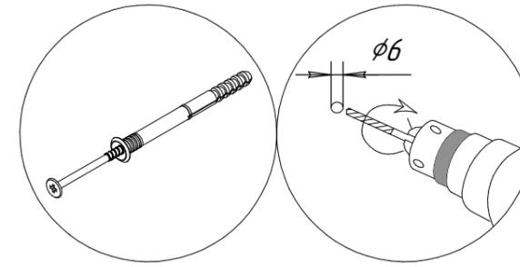
1. Просверлить отверстия  $\phi 6$  мм в задней стенке согласно схемы.
