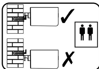
При креплении к стене, убедитесь в надежном соединении крючка навески с монтажной пластиной. Не надежное соединение грозит падением изделия во время эксплуатации.
